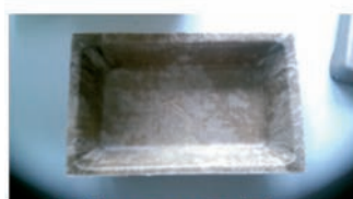
Vaschetta interamente costruita in composito biodegradabile di fibre di canapa
